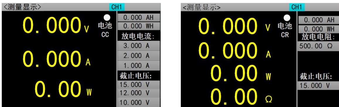
图 2.10.1 电池测试设置界面
