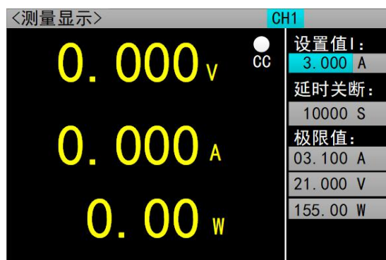
图 2.6.1 定电流测量模式
