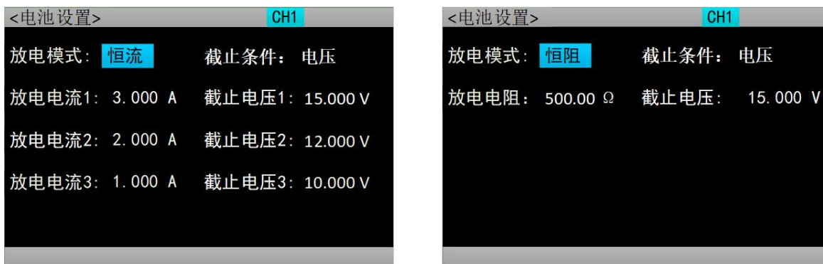
图 2.10.1 电池测试设置界面
