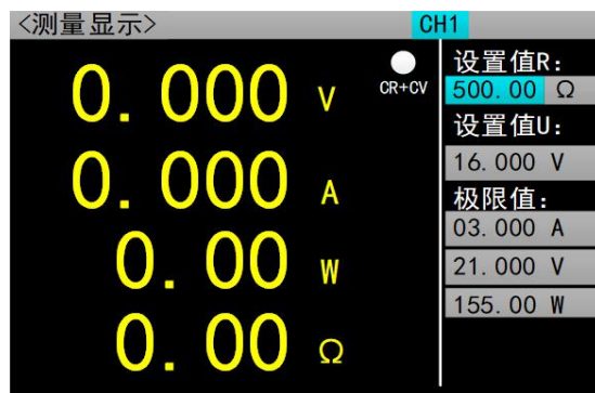
图 2.6.5 定电流转定电压测量模式
