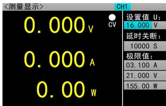
图 2.6.2 定电压测量模式
