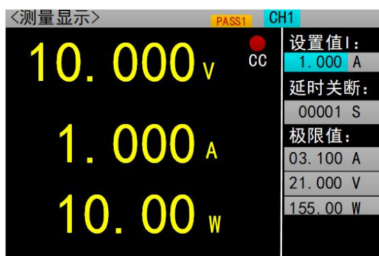
图 2.14.2 开启合格测试后的界面
