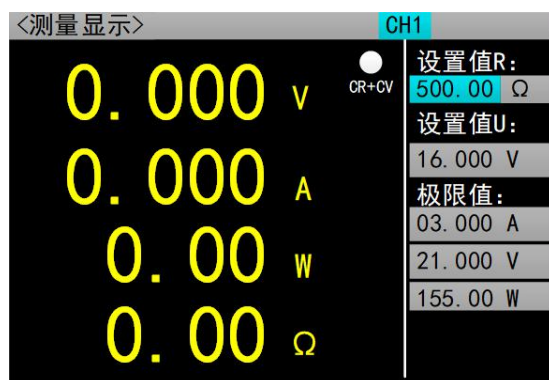
图 2.6.5 定电阻转定电压测量模式
